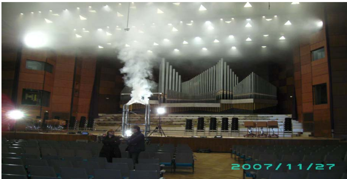
Bild 22 Rauchgaspolster oberhalb der Bühne bei Versuch 2
