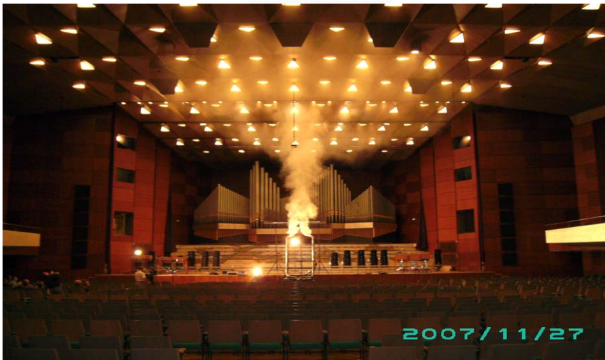
Bild 21 Vertikale Rauchgasausbreitung bei Beginn des Versuchs 1
